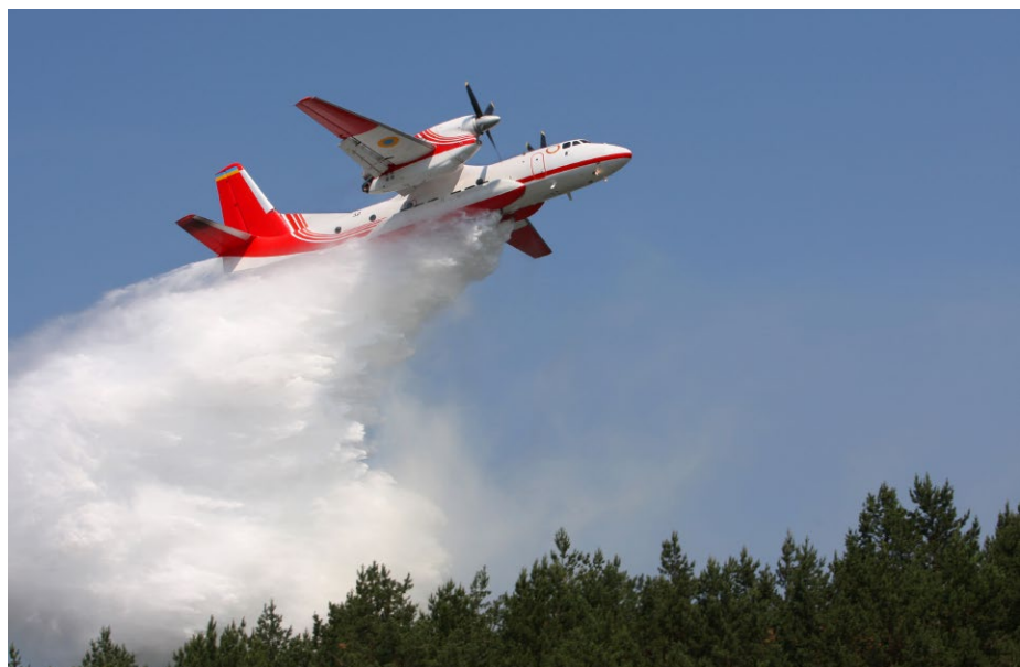
Niet-amfibische blusvliegtuigen hebben vaak een grotere watercapaciteit dan scoopers, maar hebben als nadeel dat er minder 'drops' per uur mogelijk zijn.
