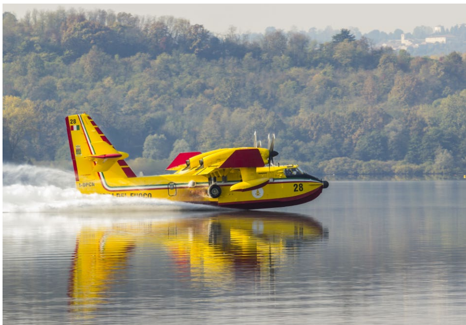
'Scoopers' - kunnen zeer snel water opnemen maar hebben meestal minder watercapaciteit dan niet-amfibische blusvliegtuigen én zijn uitsluitend geschikt voor bluswerkzaamheden.
