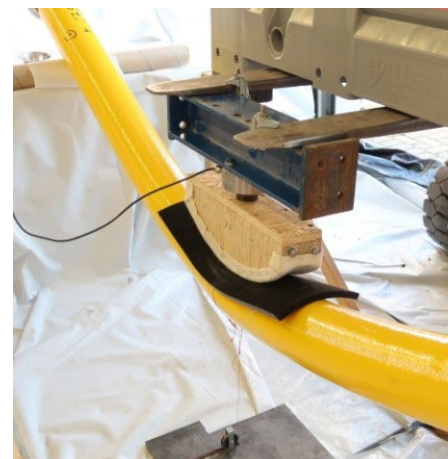
Buigstijfheidstest om een model te kunnen maken van de vervorming van een gevulde slang door zwaartekracht en luchtkrachten.
